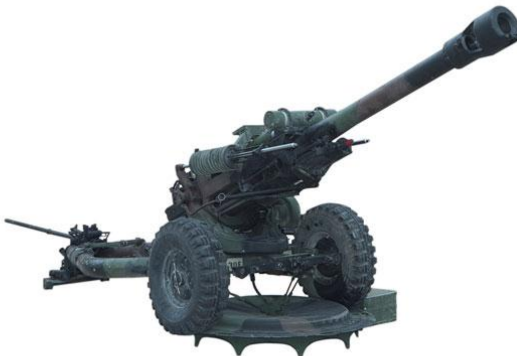
Fig. 17 - Obus Rebocado 105mm M119 LightGun
