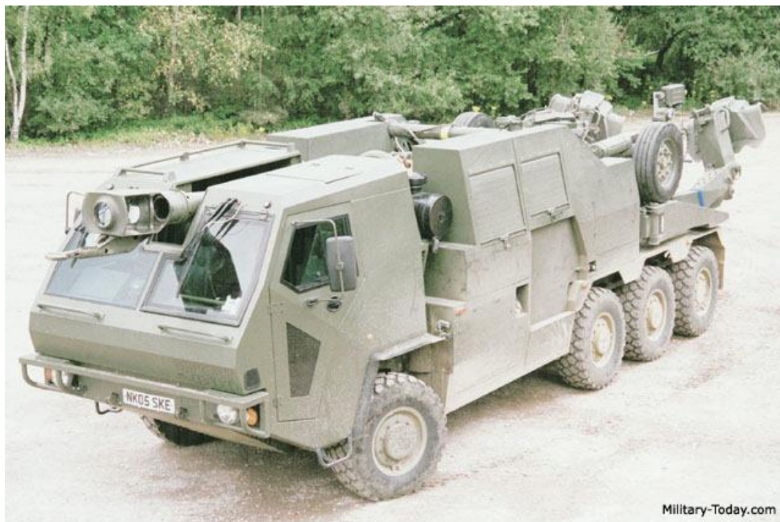
Fig. 10 – Obus Autopropulsado de Rodas 155mm M777 PORTEE/39
