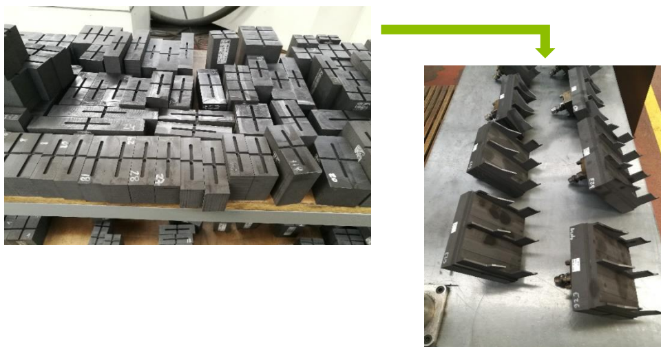
Figura 3.18 – Eléctrodos utilizados na eletroerosão por penetração
