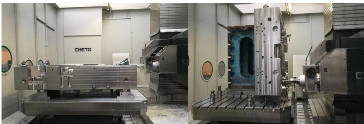
Figura 3.15 – Peça submetida à furação
