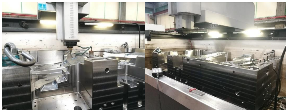
Figura 3.19 – Peça submetida à eletroerosão por penetração
