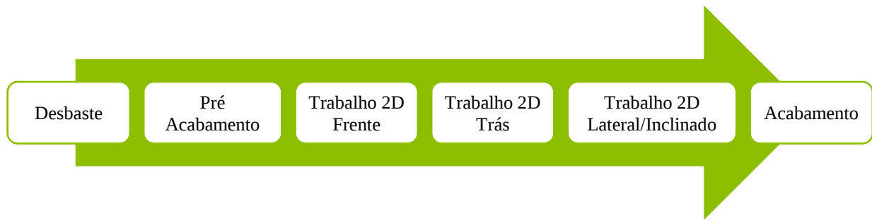
Figura 3.13 – Processos inerentes ao setor de fresagem
