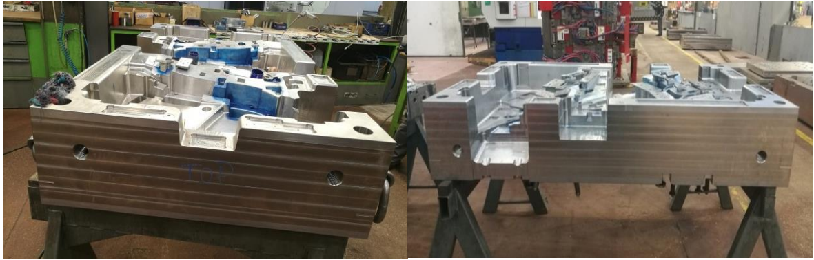
Figura 3.21 – Peça submetida ao ajuste na bancada
