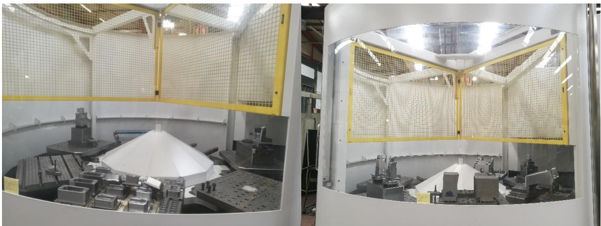
Figura 6.2 – Carrossel da máquina FE36
