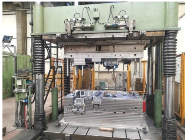
Figura 3.22 – Molde submetido ao ajuste na prensa
