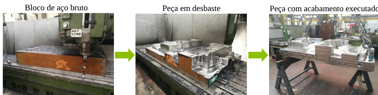
Figura 3.14 – Peça submetida à fresagem
