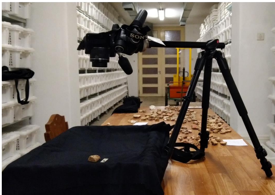
Fig. 17 – Processo fotográfico dos fragmentos de pintura, realizado com o auxílio de um tripé com braço horizontal.
