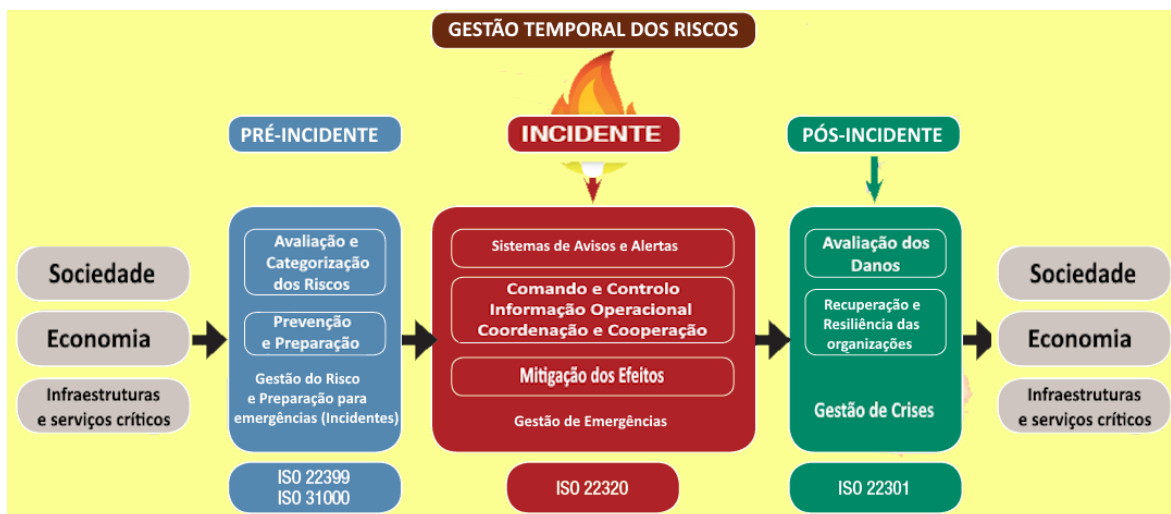
Figura 3 - Sistema de gestão temporal dos riscos (adaptado e traduzido de AENOR 2013, P. 12)
