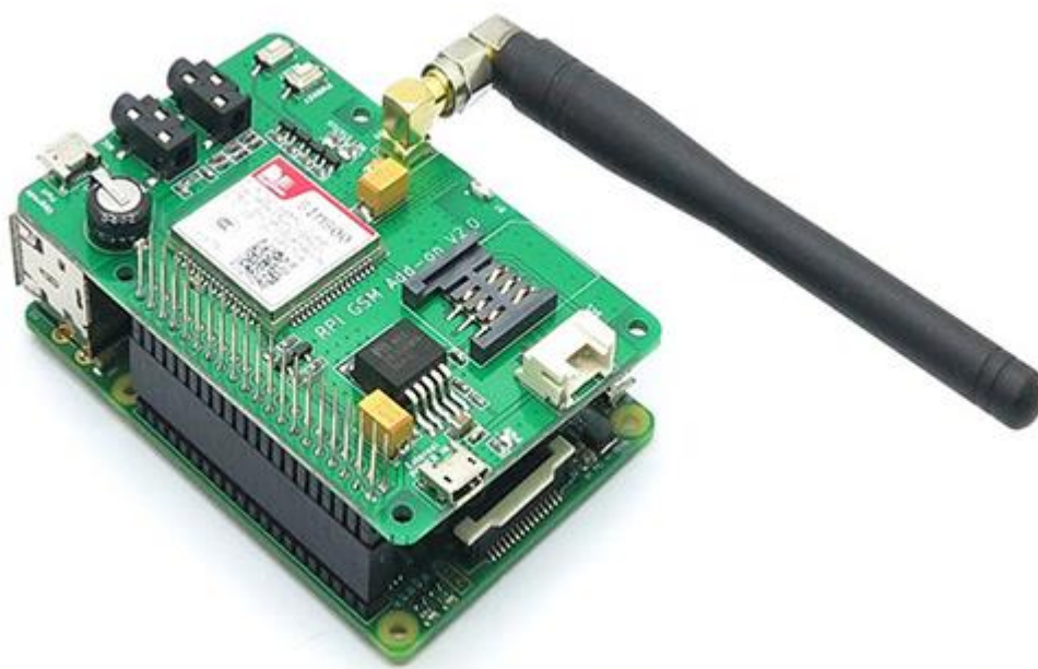
Figura 21 - Placa de expansão GSM/GRPS Sim800 sobre o Raspberry Pi
