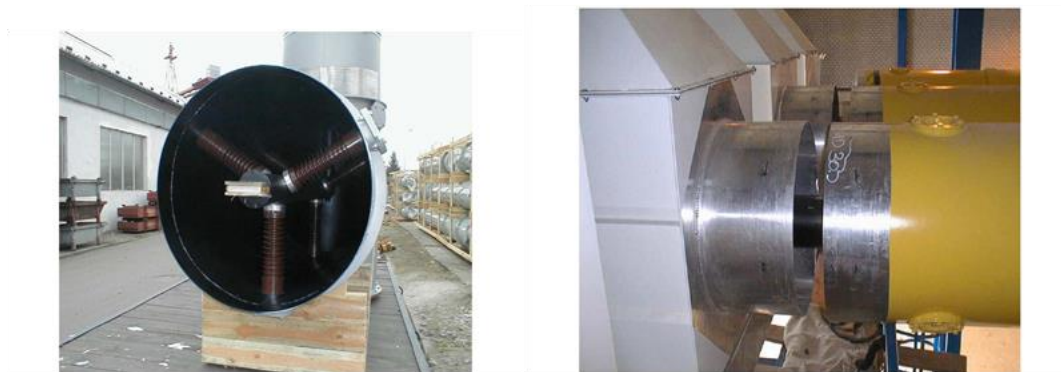
Figura 48 – Detalhes de construção do barramento.
