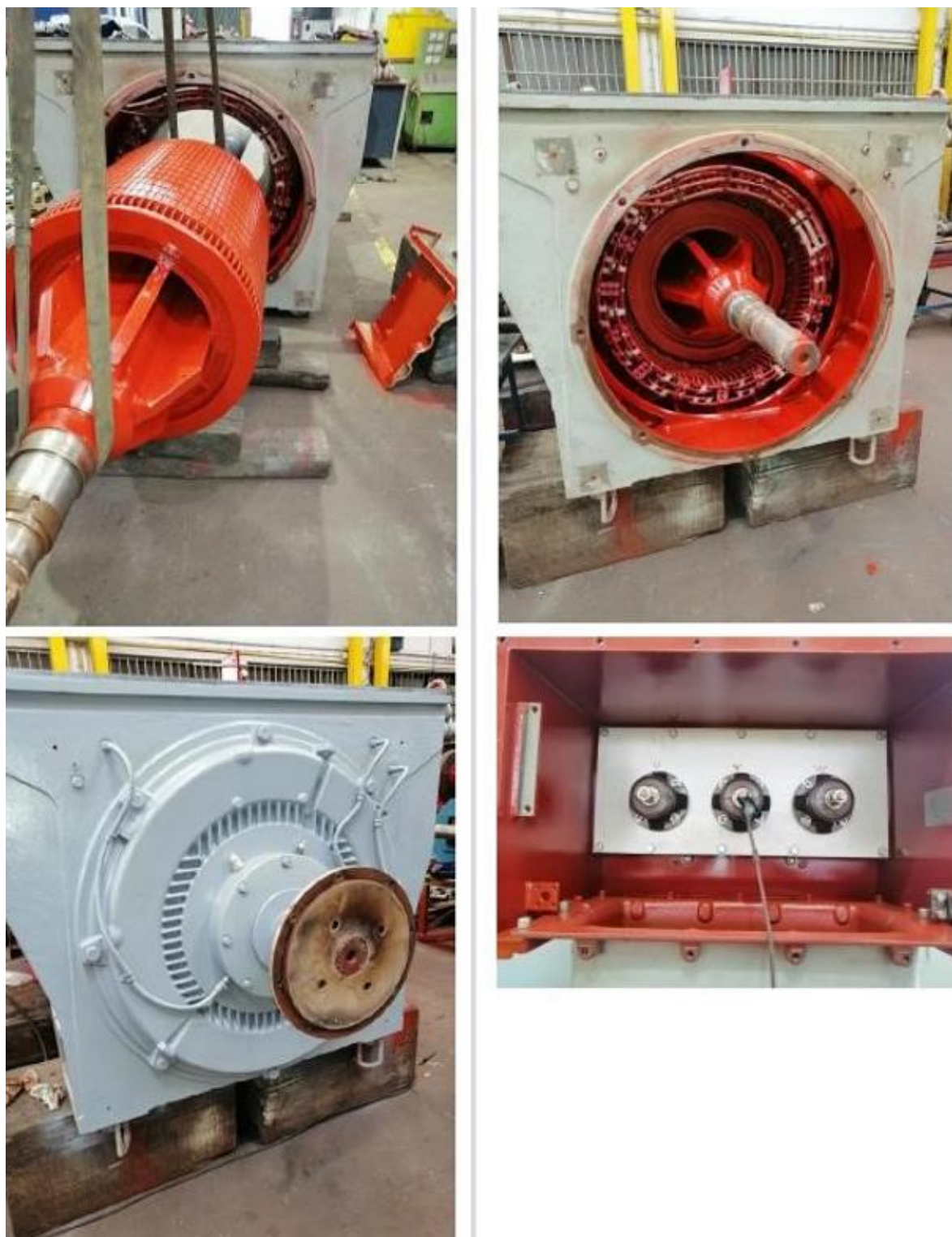
Figura 76 – Remontagem após beneficiação do motor.
