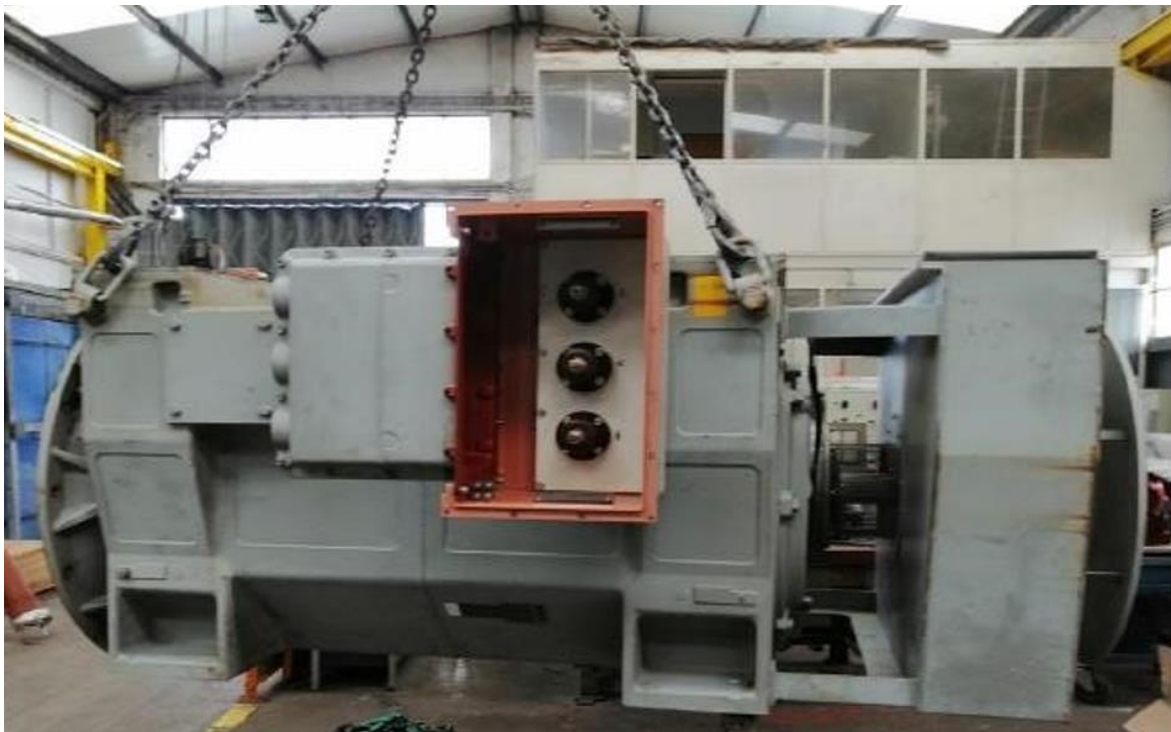
Figura 74 – Desmontagem e movimentação do motor (Fonte própria).
