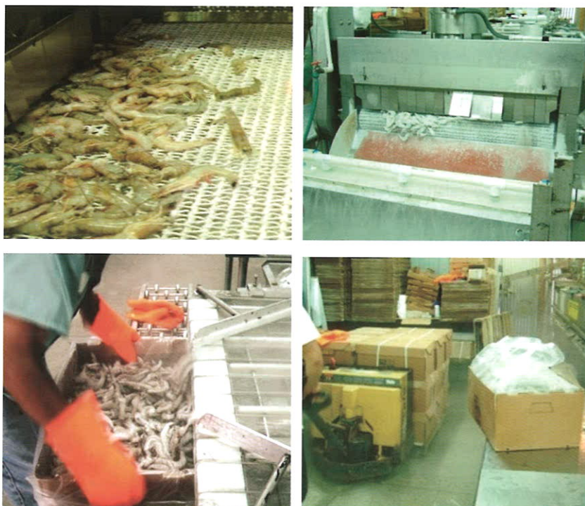
Fig. 5.10. Sequência de operações na congelação de camarão por ar forçado.
