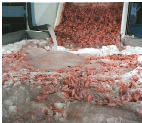
Figura 5.9. Aplicação de gelo líquido na conservação de camarão.
