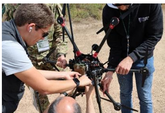
Figura n.º 36 - Acoplamento do RBE no drone Fonte: Elaboração Própria
