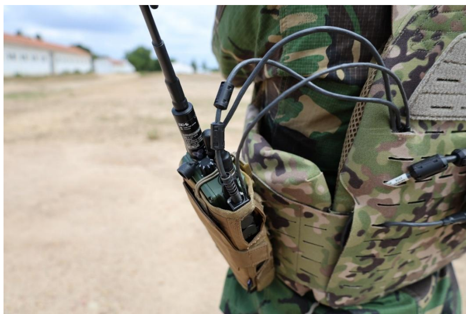
Figura n.º 50 - Rádio de Baixo Escalão (R&S HANDHELD TR-5000H -SDHR) Fonte: Elaboração Própria
