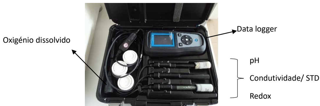
Figura 19 – Data logger Hach® e sondas de pH, condutividade/sólidos totais dissolvidos, oxigénio dissolvido e potencial oxidação-redução.
