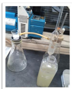
Figura 21 - Filtração da amostra a vácuo usando um cadinho filtrante e filtro de poro 0,45 µm.
