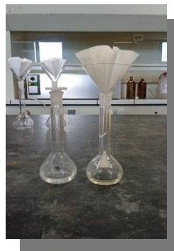
Figura 24 - A) Digestão da amostra com HCl. B) Filtração do resíduo resultante para balões volumétricos (50 mL).
