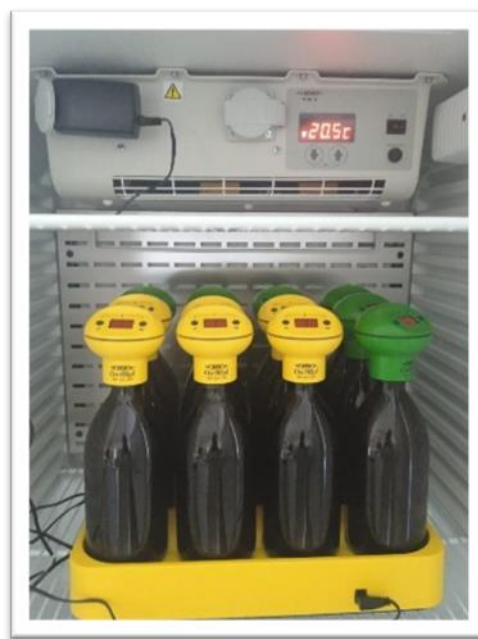
Figura 23 - Conjunto Oxitop®, garrafas de incubação, medidor de pressão Oxitop®, placa de agitação em incubadora a 20 °C.
