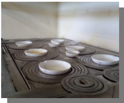
Figura 24 - A) Digestão da amostra com HCl. B) Filtração do resíduo resultante para balões volumétricos (50 mL).
