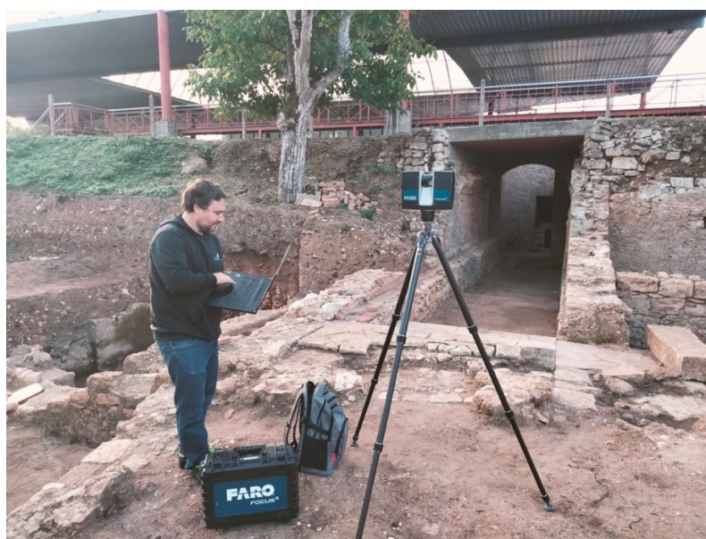
Fig. 10 – Numérisation des structures au scanner (R. Costeira da Silva 2022)
