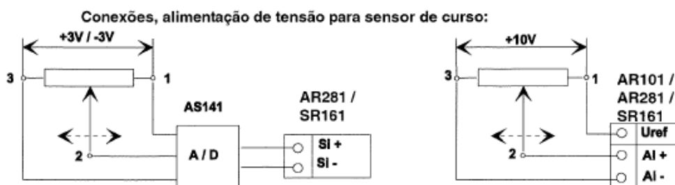
Figura 71 - Conexões, alimentações de tensão para os transdutores [40]
