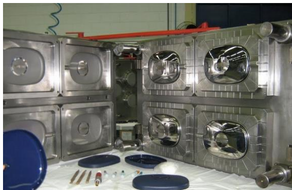
Figura 18- Molde para injeção de plásticos
