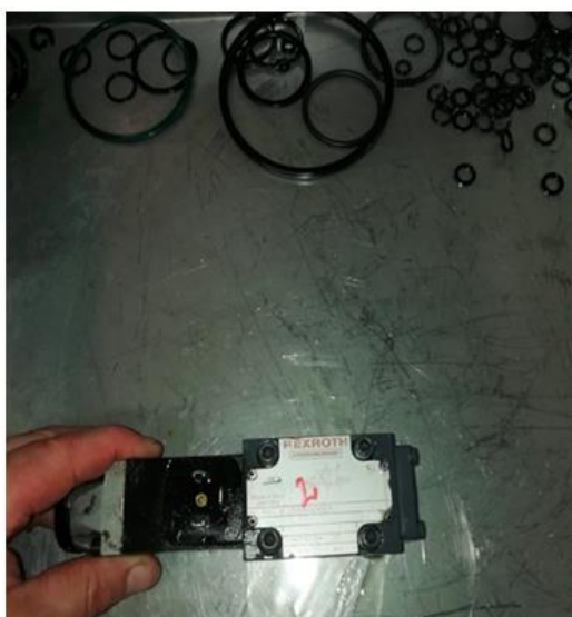
Figura 61 - Reparação de válvulas hidráulicas
