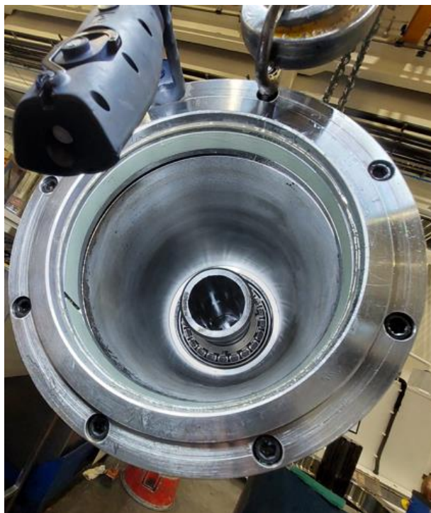
Figura 60 - Piston de injeção reparado
