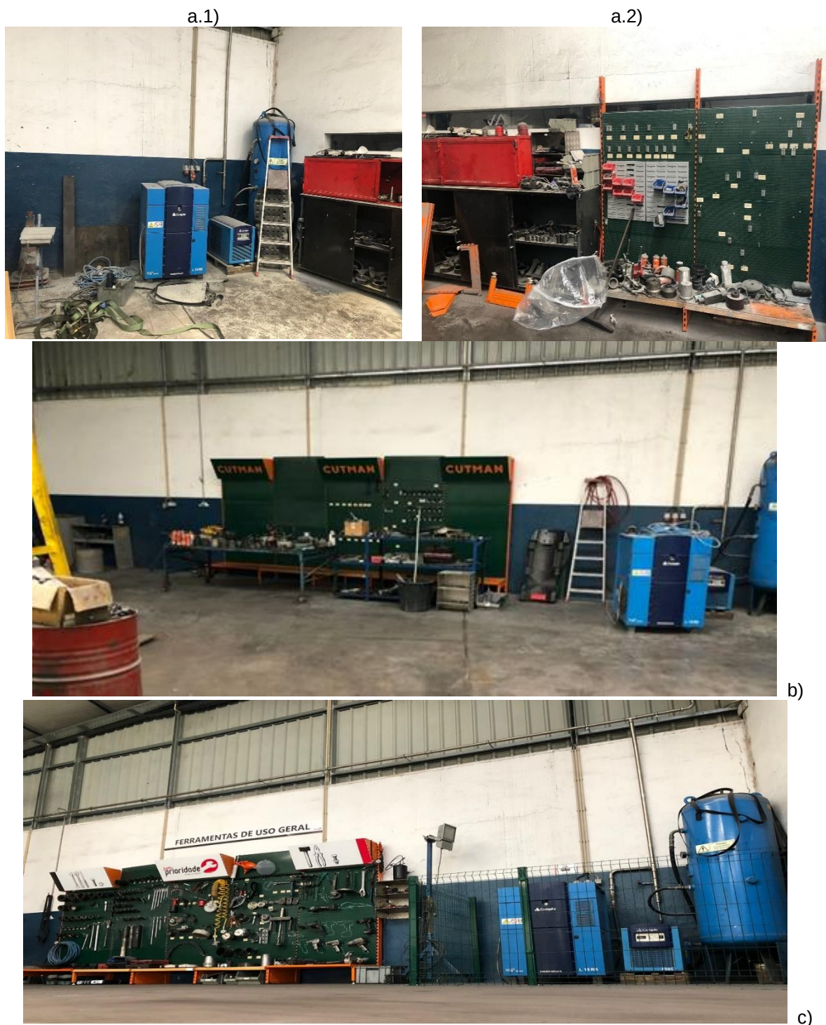
Figura 4.8. Implementação 5S das Zonas de Maior Intervenção; a) Antes da implementação; a1) Zona do Compressor de Ar ao Início; a.2) Painel de Ferramentas Inicial; b) Fase Intermédia; c) Fase Final.
