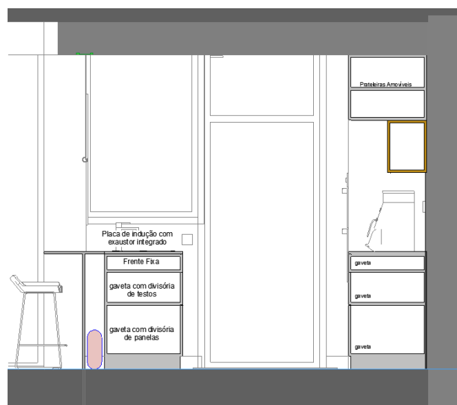
Imagem 47 | Corte Transversal Cozinha
