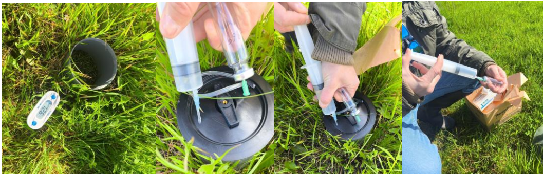
Figura 17 - Procedimento de instalação e coleta de gases do solo com tubos fixados ao nível do solo e medição da temperatura do solo.
