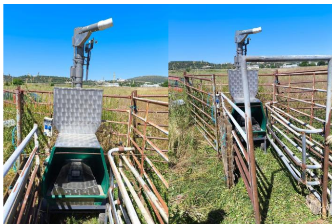
Figura 16 - GreenFeed®, equipamento utilizado para medição individual das emissões entéricas de metano (CH 4 ).
