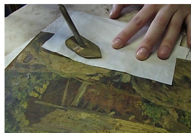
Figura 72 | Utilização da espátula quente para ativação mais rápida da presa do adesivo
