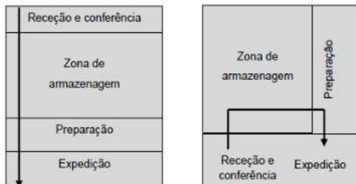
Figura 3 – Representação do fluxo direcionado (esquerda) e do fluxo quebrado (direita) (Carvalho et al., 2010).
