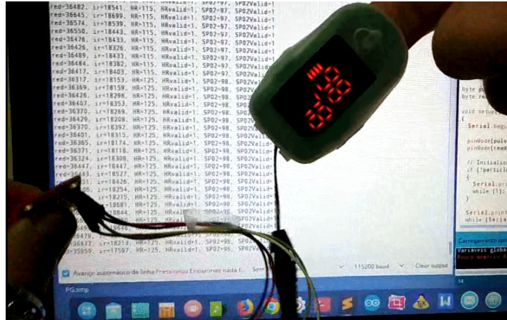
Figura 6.2: Teste Sensor MAX30105 - Aparelho do INEM
