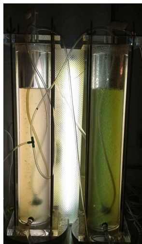
Figura 45 – Imagem dos fotobiorreatores com microalga Chlorella minutissima à esquerda e microalga Chlorella sp. à direita.
