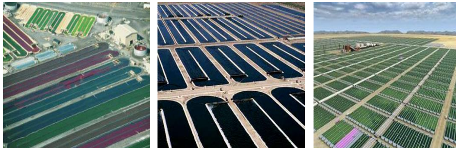
Figura 9 - Produção industrial do microalgas em lagoas raceway [10].
