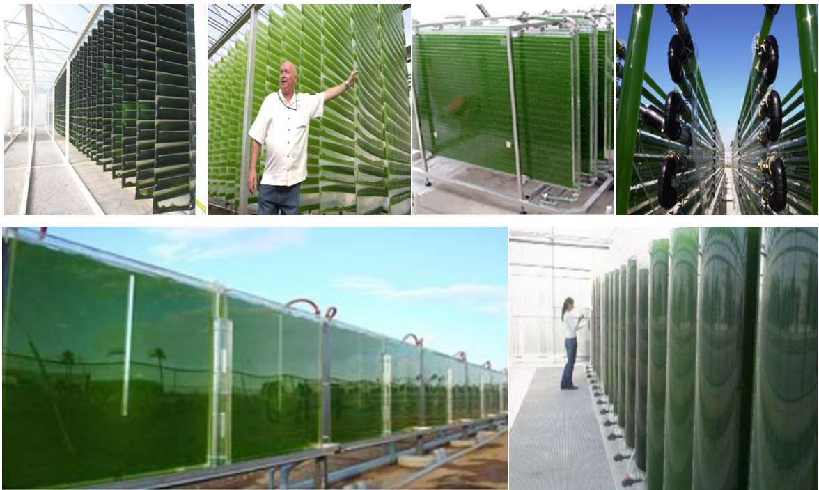
Figura 12 - Produção industrial do microalgas em fotobiorreatores [10].
