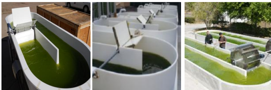
Figura 10 - Lagoas raceway utilizadas em investigação [10].
