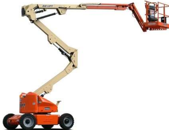
Figura 22 - Equipamento de elevação de pessoas a utilizar para o resgate de trabalhadores (Vendap, 2021)
