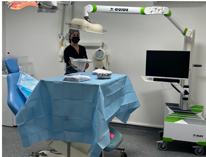
Figura 19: Fotografia da instalação do sistema de navegação dinâmica X-Guide® (X-NAV Technologies, LLC, Lansdale (Pensilvânia, Estados Unidos) em cirurgia implantológica. O dispositivo é composto por um braço de navegação ótica ligado a um ecrã de controlo permitindo a visualização em tempo real da perfuração e da colocação dos implantes
