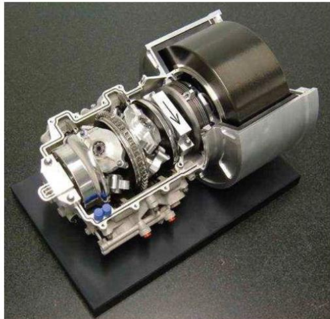
Figura 54 - Exemplo de flywheel usado num sistema de recuperação de energia cinética destinado à indústria automóvel [47]
