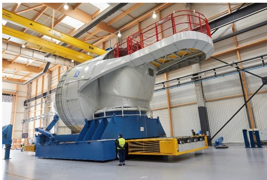
Figura 131 - Nacelle do aerogerador Haliade 150-6MW, na linha de montagem da fábrica de Saint Nazaire [100]
