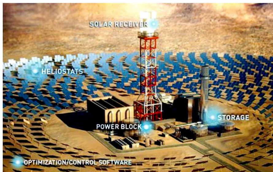
Figura 59- Representação de uma central de concentração de energia solar [44]
