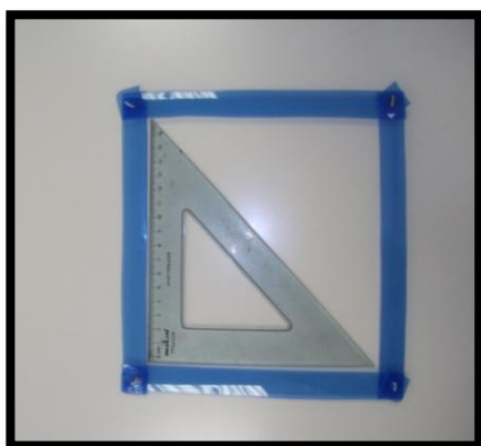
Quadrilátero articulado na posição de quadrado.
