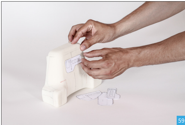
[57];[58];[59] Modelo em espuma utilizado para testar vários desenhos (recortados em papel) para a zona do carregamento
