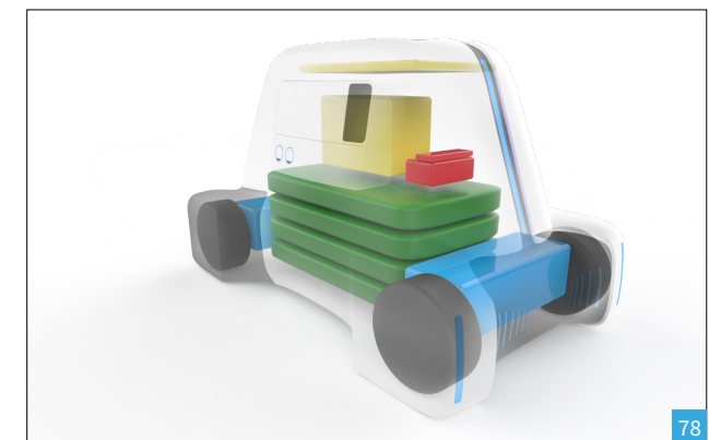
[78] Modelo 3D com a distribuição dos volumes (estimados) dos componentes principais
