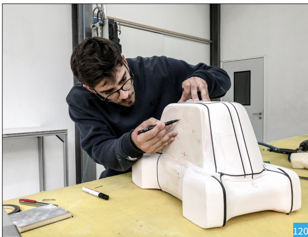
[120] Apreciação dos defeitos e pequenas deformações nas superfícies com massa
