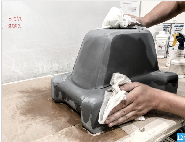
[124] Processo de limpeza para a pintura, máscara e pintura
