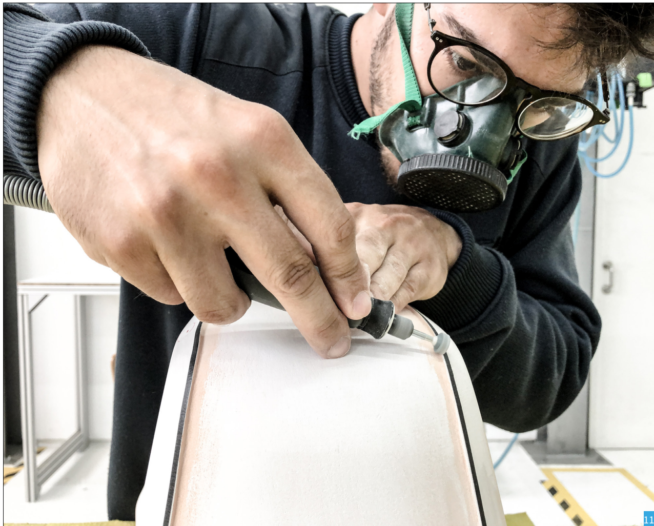
[119] Processo do tratamento das superfícies e recorte dos limites da forma
