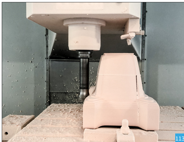
[113] Processo de maquinação com fresa de desbaste
