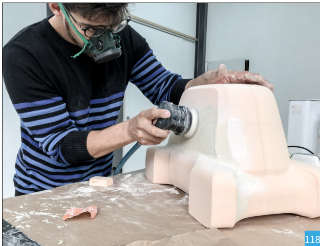
[118] Processo inicial do tratamento das superfícies com lixadora
