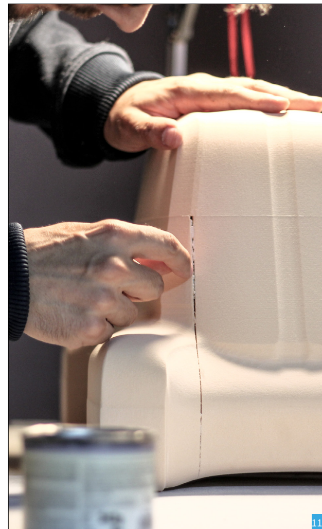
[115] Lixar e cobrir fissuras
