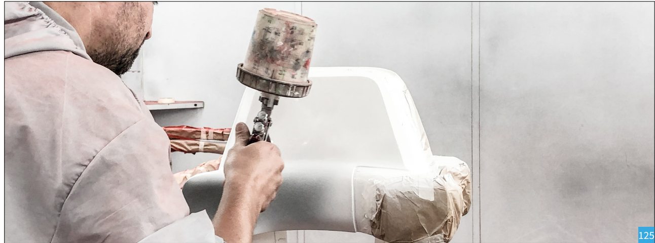
[125] Processo de pintura com máscaras para isolar as diferentes cores
