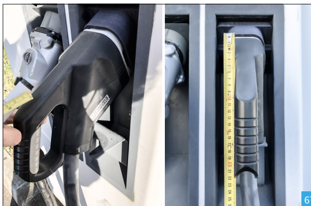
[67] Dimensão de um conector Tipo 2 (combo)
