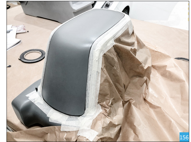
[156] Máscara utilizada para as diferentes camadas da pintura
