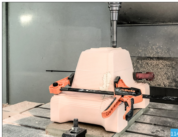
[114] Processo de maquinação com fresa esférica
