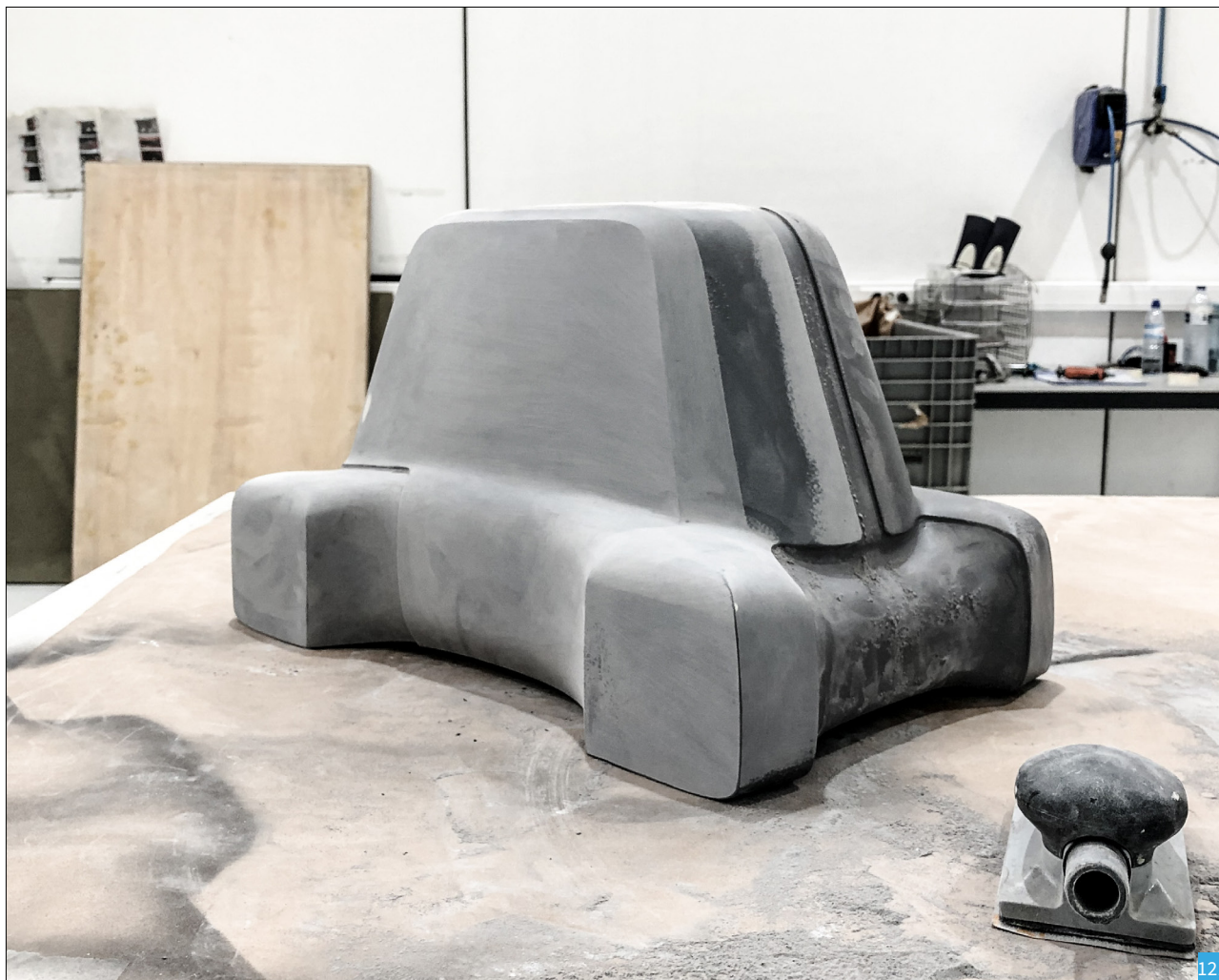
[121] Depois de aplicado primário o modelo foi lixado e preparado para pintura
