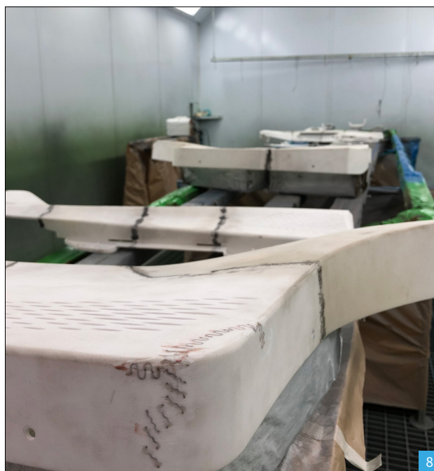
[8] Peças do interior do Buddy, prontas para a aplicação de primário
