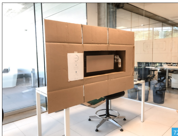
[69];[72] Maquete em cartão escala 1:1, colocado à altura real de forma a testar a usabilidade com mais veracidade
