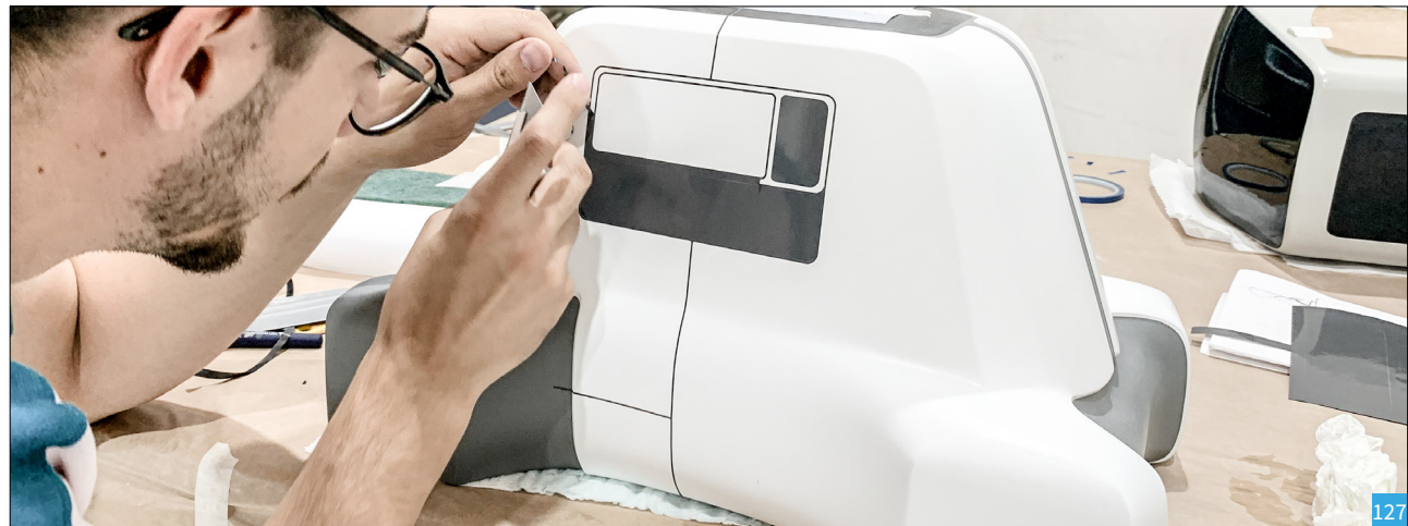
[127] Aplicação de vinil para simular os recortes e iluminação do projeto
