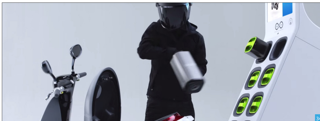
[34] Infraestrutura de carregamento e troca de baterias da GOGORO
