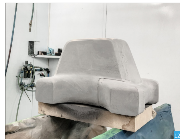
[123] Modelo preparado para a segunda aplicação de primário
