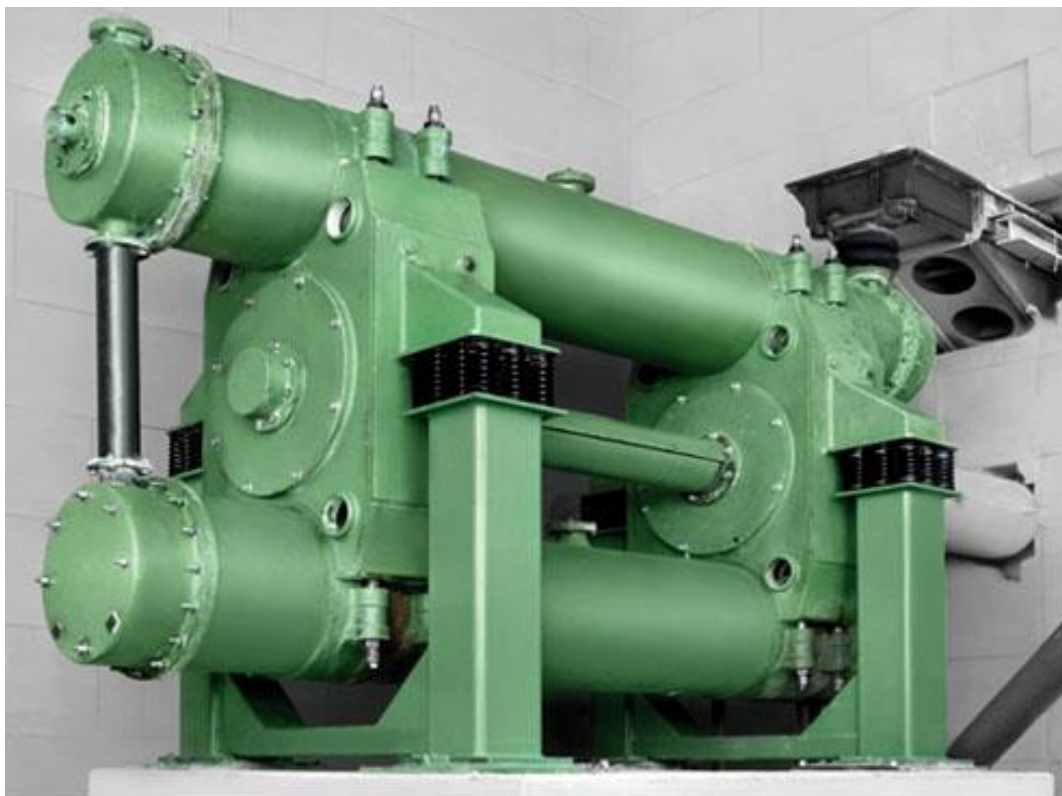
Figura 4.6 – Moinho vibratório. (Fonte: MBE COAL & Minerals Technology Holding GmbH, s.d.)
