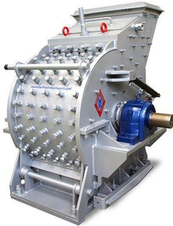
Figura 4.8 – Moinho de martelos. (Fonte: Manfredini e Schianchi, 2009)
