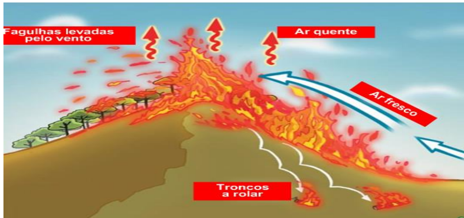
Figura 17: Projeção e deslocamento de matéria inflamada.
