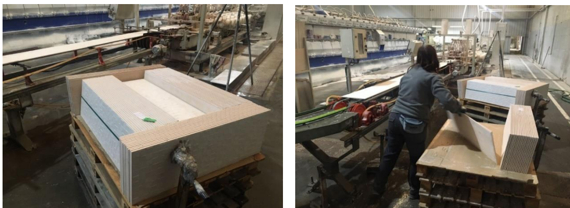
Figura 70 – Imagens reais de despaletização manual em linha Fonte: Própria
