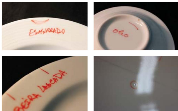
Figura 104 – Exemplos típicos de defeitos encontrados nas peças cerâmicas Fonte: Própria
