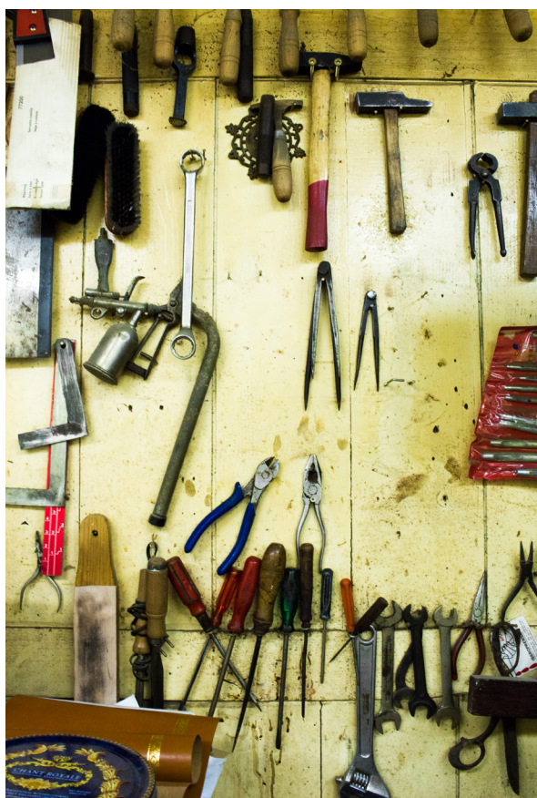
FIGURA 95 Ferramentas manuais (ferros, esquadros metálicos, tesouras, compassos, alicates, alicates de nervos e martelos)
