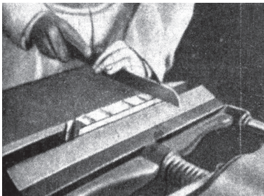
FIGURA 22 Serrotagem O papel de texto (miolo) era serrado, provocando sulcos recortados ao longo da parte de trás das seções, nas quais as cordas eram afundadas de modo a obter-se no livro uma superfície lisa, quando coberto com couro. A prática de “serrar” os livros vulgarizou-se entre os encadernadores europeus: esta técnica facilitava a costura dos cadernos e permitia obter lombadas lisas (isto é, sem nervos salientes) mas, punha em causa a qualidade funcional das costuras.
