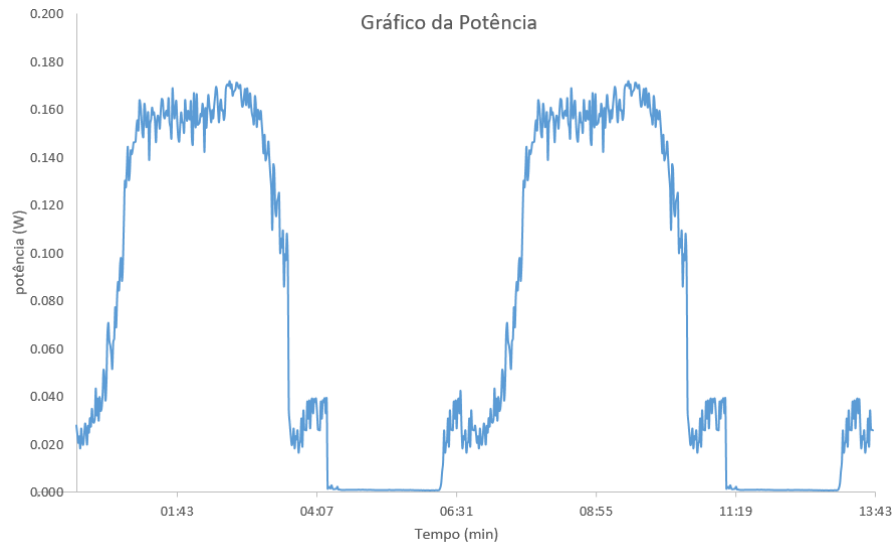
FIGURA 4.5: Gráfico da potência gerada pelo painel fotovoltaico pequeno
