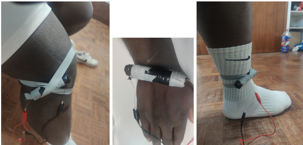
FIGURA 4.11: Posição da bobine para a realização dos testes. 1- Joelho, 2 - Pulso, 3 - Pé
