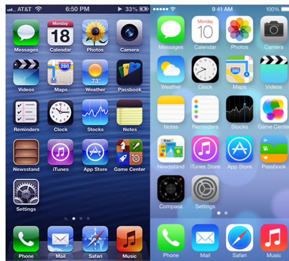
Figura 8 Comparação entre estilos através de ícones - Esqueumorfismo vs Flat Design - (iOS 6 vs iOS7 – iPhone, Apple)
