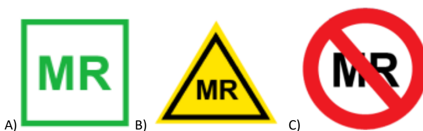
Figura 9: Categorias de segurança dos dispositivos. A) RM Seguro; B) RM Condicional; C) RM Inseguro (30) .
