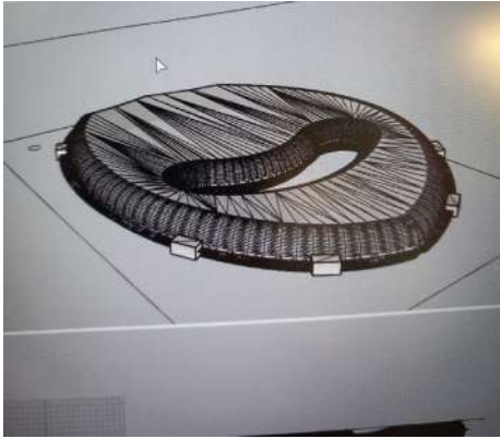
Figura 78. Representação digital do objeto pronto para ser impresso na CNC.
