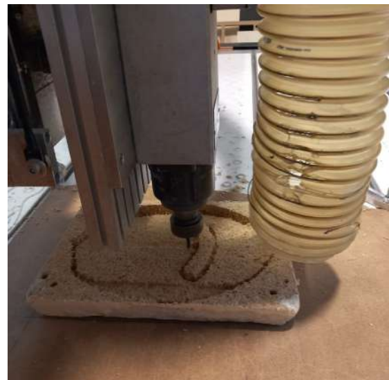
Figura 79. Processo de corte da placa de micélio na CNC.
