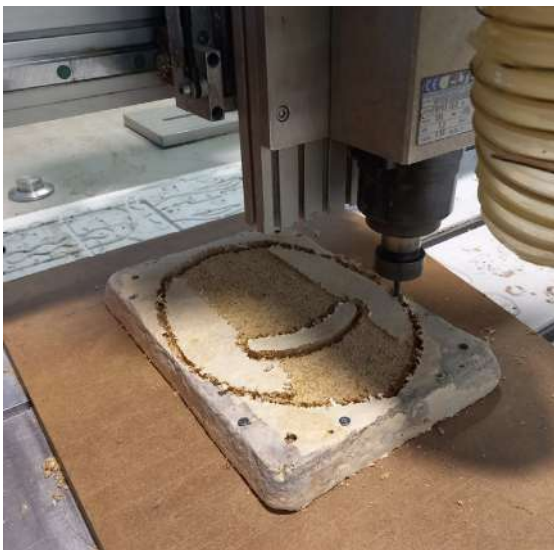
Figura 79. Processo de corte da placa de micélio na CNC.
