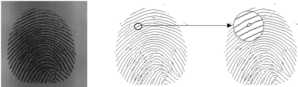
Figura 31 – Alterações na estrutura das cristas devido ao ruído.
