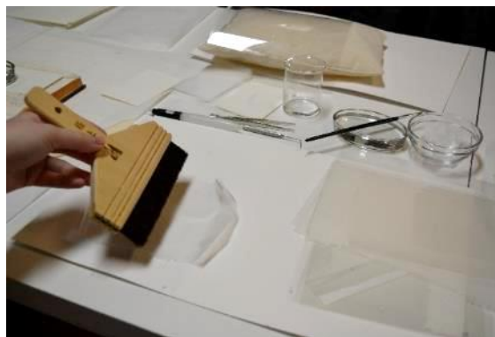
Figura XIII 18: Humidificação do papel pré-encolado com gelatina a 3%.
