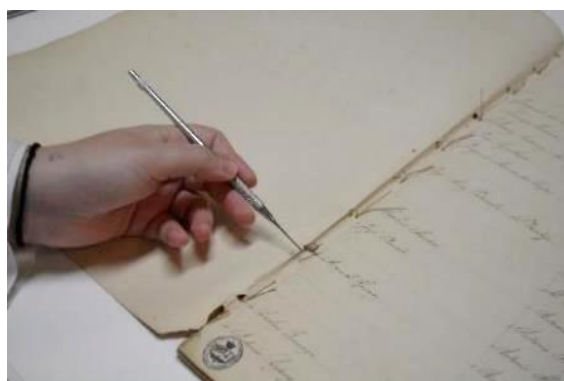
Figura 54: Fotografia que demonstra a remoção do fio de costura dos furos de costuras dos fólhos.
