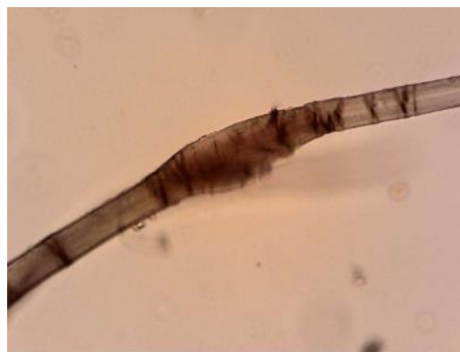
Figura 47: Fibra do fio de costura, Herzberg 200x, livro 372
