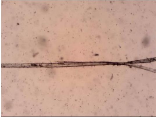
Figura 35: Fibra do fio de costura, Loftton-merritt 50x, livro 371
