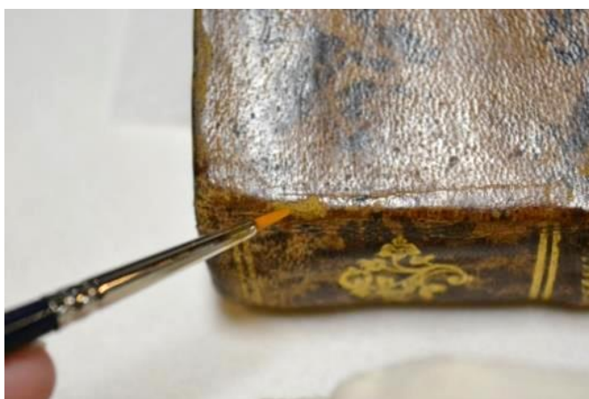
Figura 73: Tingimento pontual do couro com uma aguada de anilinas vegetais.
