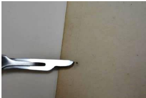
Figura 57: Fotografia da limpeza por via seca – limpeza com bisturi.
