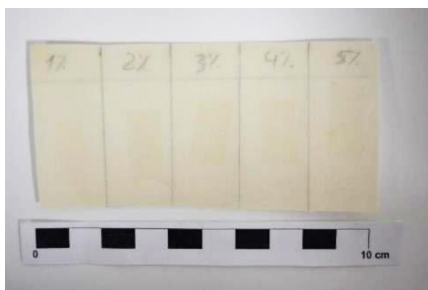
Figura 96: Teste da percentagem da cola de gelatina.
