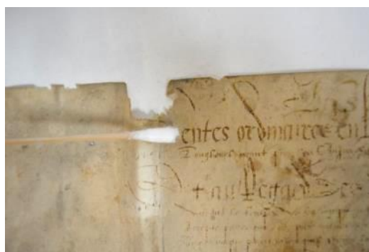
Figura XV 16: Teste de solubilidade dos materiais de registo no pergaminho (cotonete).
