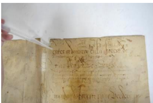
Figura XV 15: Teste de solubilidade dos materiais de registo no pergaminho (pipeta).
