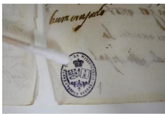
Figura XV 20: Teste de solubilidade dos materiais dos carimbos (cotonete).
