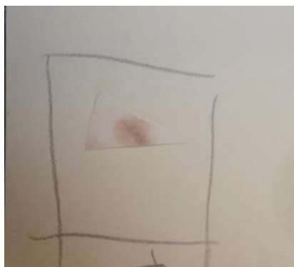
Figura XIV 12: Papel indicador de iões de ferro (II) com resultado positivo.
