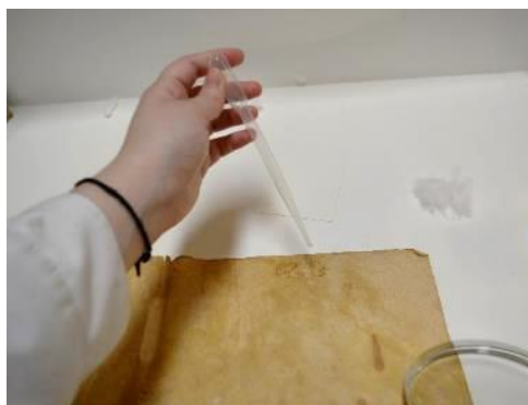
Figura XIV 14: Teste de solubilidade dos materiais de registo na capa (pipeta)
