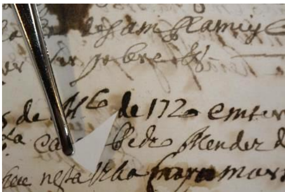
Figura XIV 11: Teste com papel indicador de iões de ferro (II).
