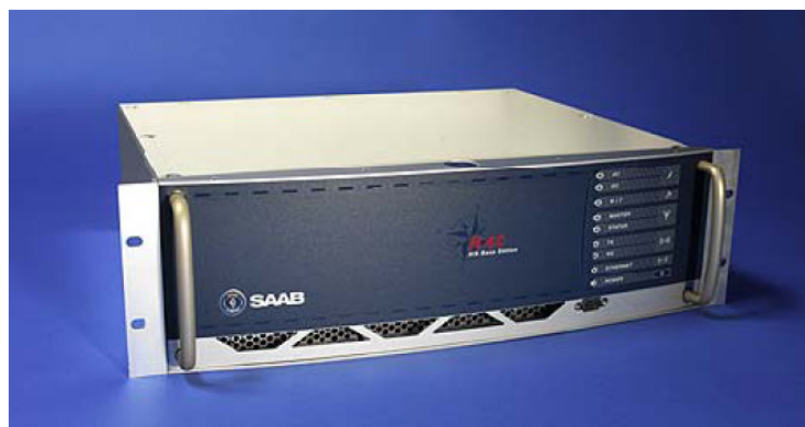
Figura 11 – Estação base AIS R40 da SAAB
