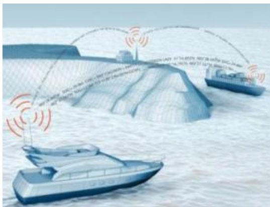
Figura 9 – Ilustração do funcionamento do sistema AIS
