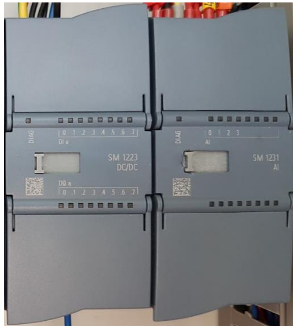
Figura 48 – Módulos digitais e analógicos adicionados ao PLC
