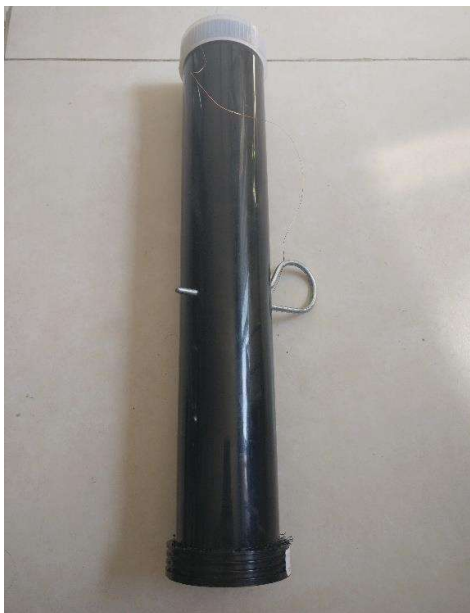
Figura 50 – Sonda XBT T4 utilizada para leitura do perfil de temperatura para a amostra de valores de teste.
