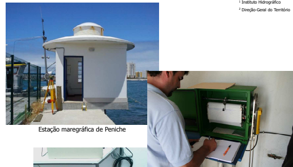
Marégrafo de flutuador com registo analógico e digital
