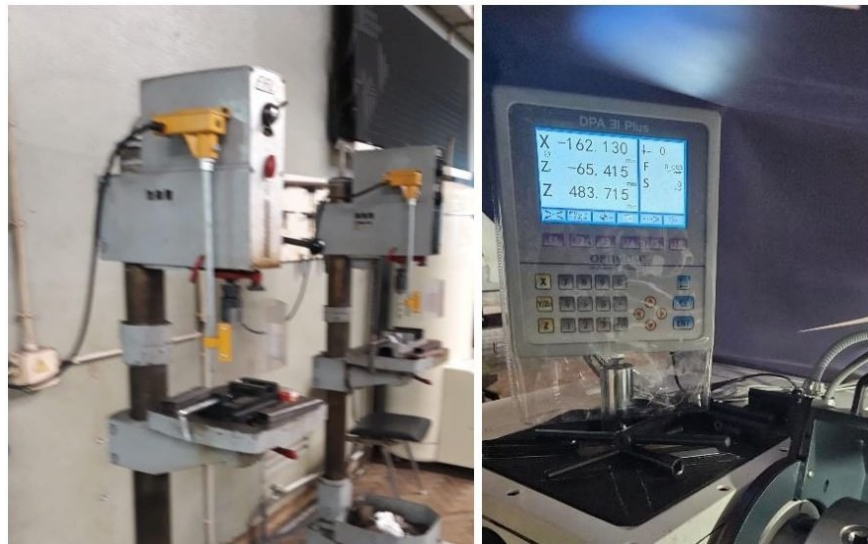
Figura 7 - Engenho de furar vertical/Display digital de coordenadas
