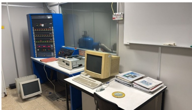
Figura 6 - Painel de recolha de dados TECNER do motor diesel
