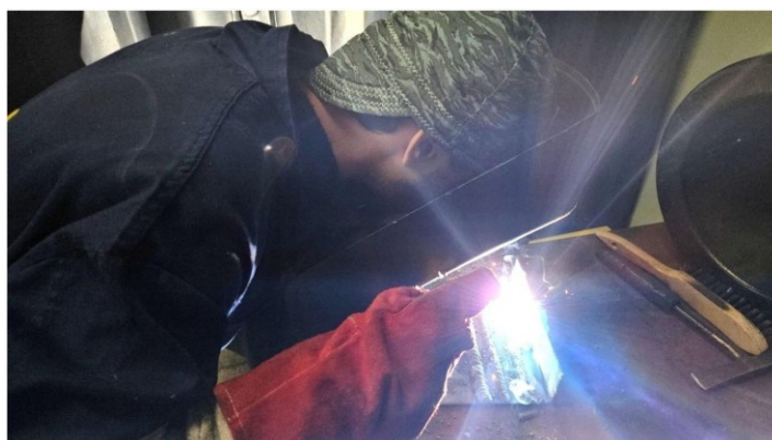
Figura 17 - Aluno executando cordão de soldadura ao baixo/canto
