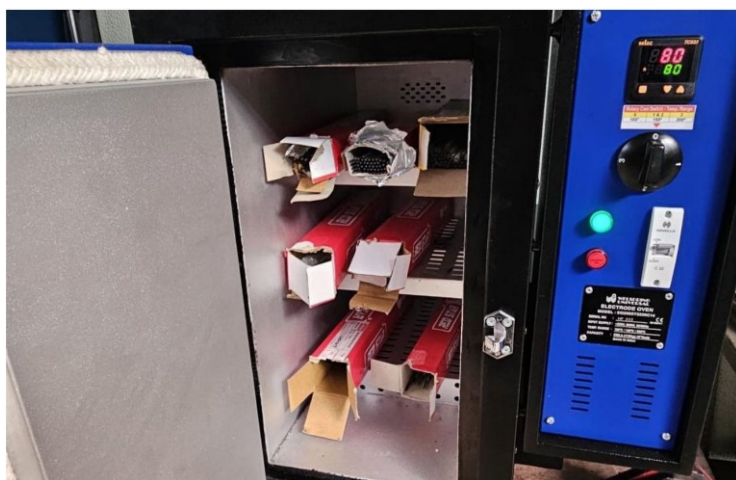
Figura 14 - Estufa para manter e eliminar humidade de consumíveis de soldadura
