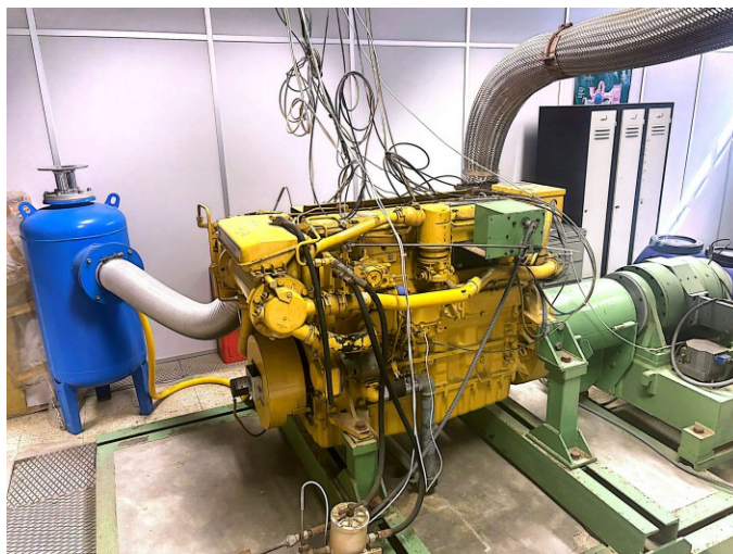
Figura 5 - Motor e Freio - Banco de Ensaios Motores Diesel
