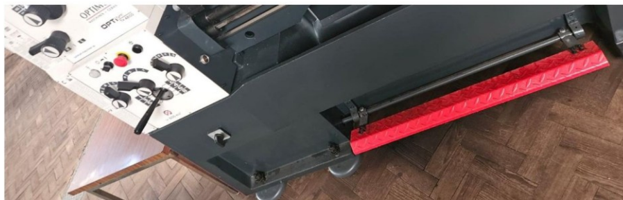
Figura 8 - Sistema duplo de paragem de emergência
