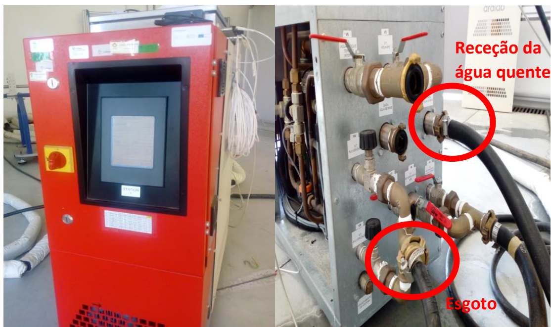
Figura 24 - Equipamento de aquisição de dados (à esquerda) e Mangueiras de saída da água (à direita)
