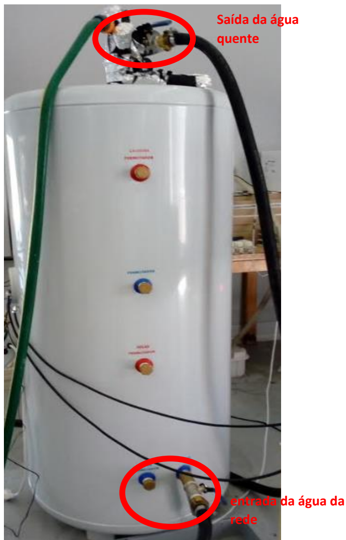
Figura 20 - Ligações do reservatório de água
