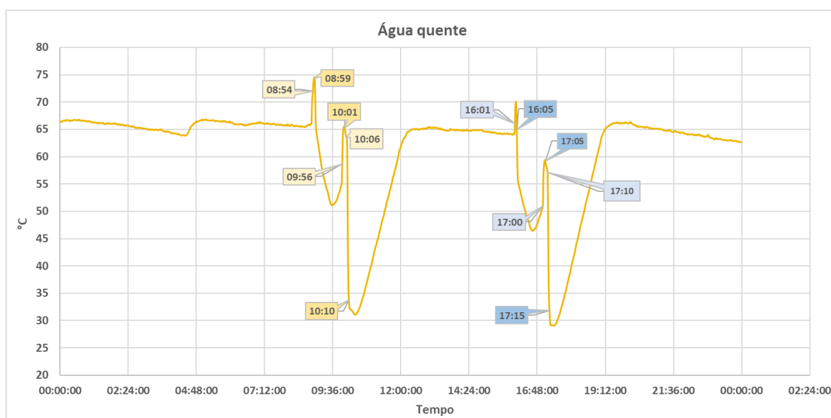
Figura 36 - Diagrama da temperatura da água em função do tempo para 3 pessoas (perfil L)
