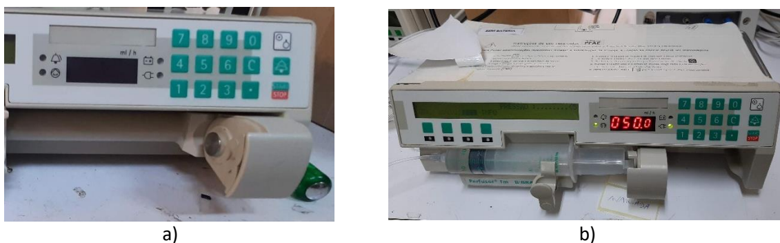
Figura 14. Bomba Perfusor fm. a) Sistema móvel, garras e sensor. b) Equipamento pronto para iniciar terapia.
