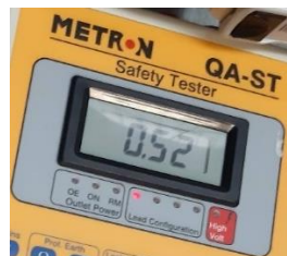
Figura 72. Teste de resistência de terra.
