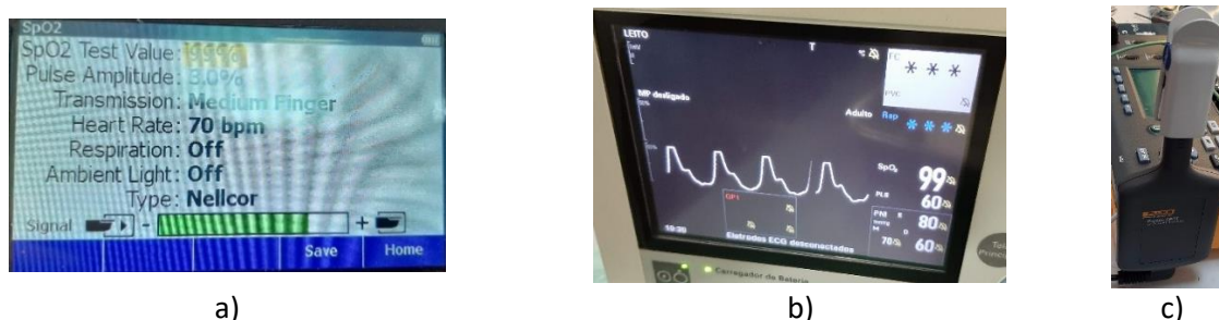
Figura 70. Teste de SpO2. a) Ecrã do ProSim 8, menu de teste SpO2. b) SpO2 medido no monitor de sinais vitais. c) Conexão do sensor no equipamento de teste.
