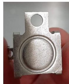
Figura 36. Termostato que se encontra ligado à caldeira.
