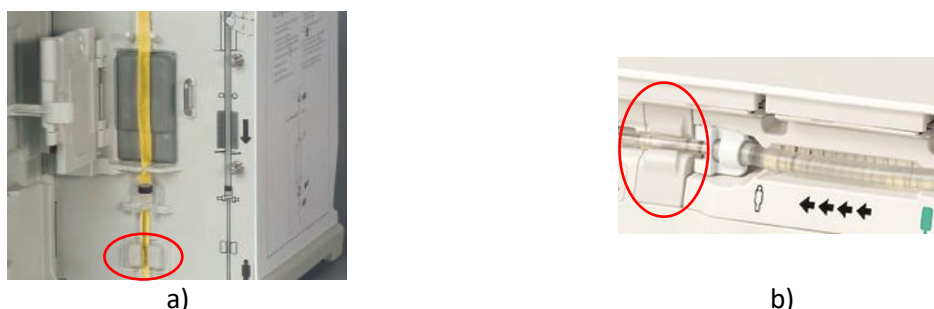
Figura 9. Sensor de ar na linha de bombas de infusão volumétricas. a) Infusomat fms. b) Infusomat Space.
