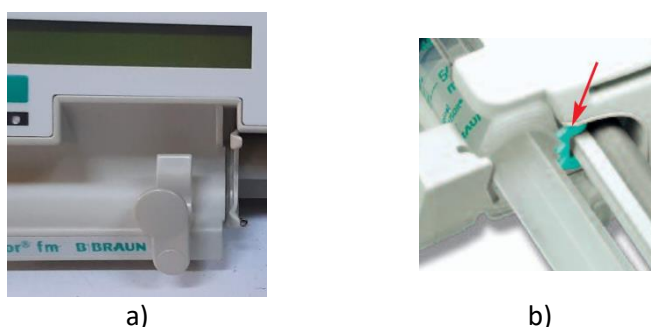
Figura 13. Zona de fixação de seringa das bombas de infusão de seringa. a) Perfusor fm. b) Perfusor Space.
