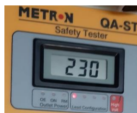
Figura 73. Teste de corrente de fuga.
