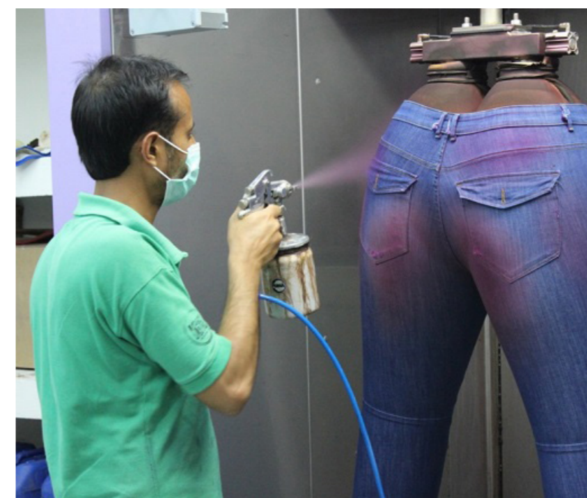
Imagem 36 - Aplicação de PP Spray.
