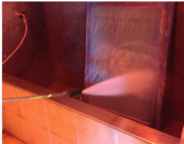
Imagem 196 - Limpeza com água do quadro para o excesso da emulsão cair e assim ficar com o desenho gravado.
