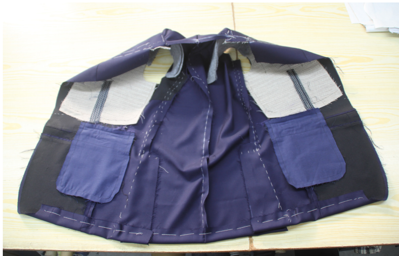
Imagem 184 - Interior do casaco alinhavado com crina, entretelas e forro dos bolsos.
