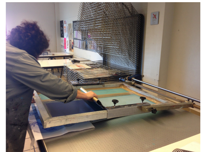
Imagem 199 - Aplicação e distribuição da tinta pelo quadro recorrendo ao auxílio de uma raclete.
