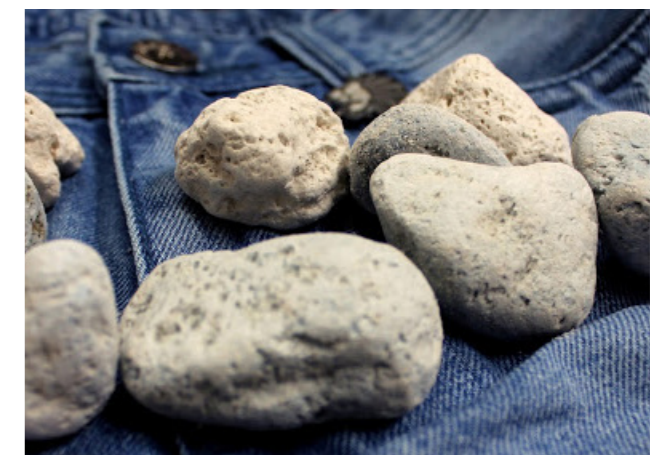
Imagem 40 - Pedra pomes usada em Stone Washing.
