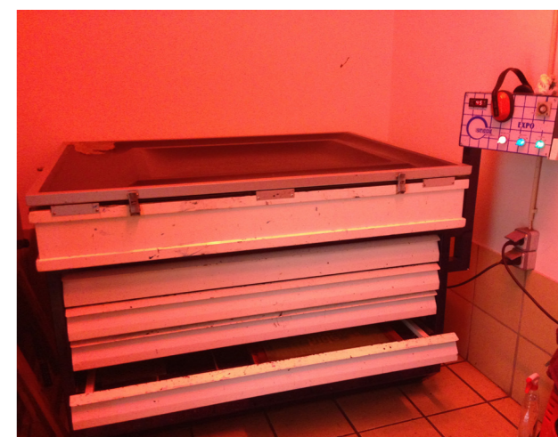
Imagem 195 - Exposição à luz do quadro emulsionado em prensa de contacto própria. Durante este tempo de exposição à luz ocorre uma reação química fazendo com que a emulsão endureça e a rede fique impermeabilizada com a exceção do local onde se encontra o desenho pois a cor preta do fotolito não permite que a luz reaja com a emulsão.
