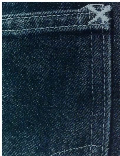
Imagem 11 - Aplicação de mosqueado pela Lee para substituir os rebites.
