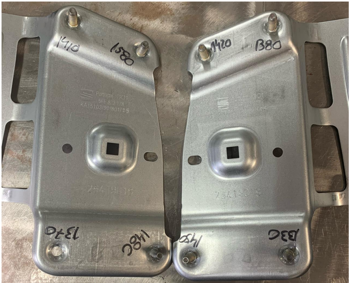
Figura 39 - Resultado ao teste de performance normativa dos pernos-parafusos
