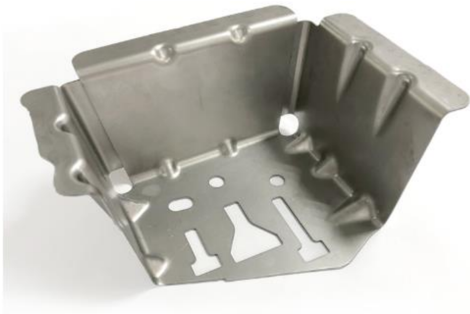
Figura 02 - Produto final com espessura 1,6 mm
