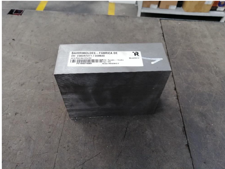
Figura 29 - Aço ainda por maquinar
