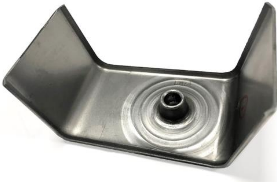
Figura 04 - Produto final com espessura variável
