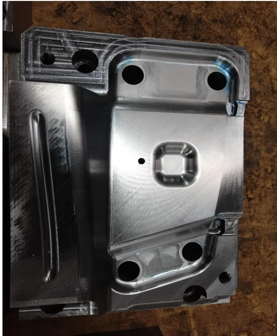
Figura 32 - Matriz de estampar com elementos postigos implementados
