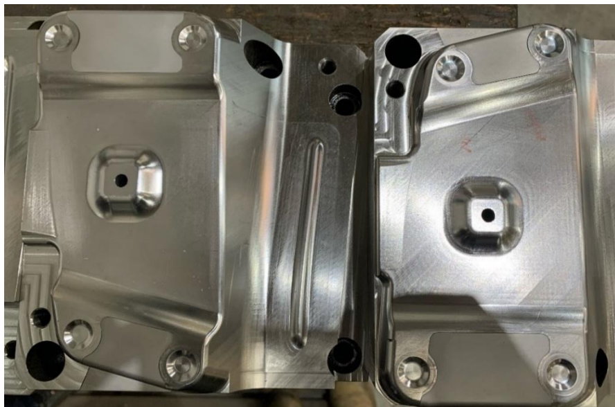
Figura 33 - Punções de estampar com elementos postigos implementados
