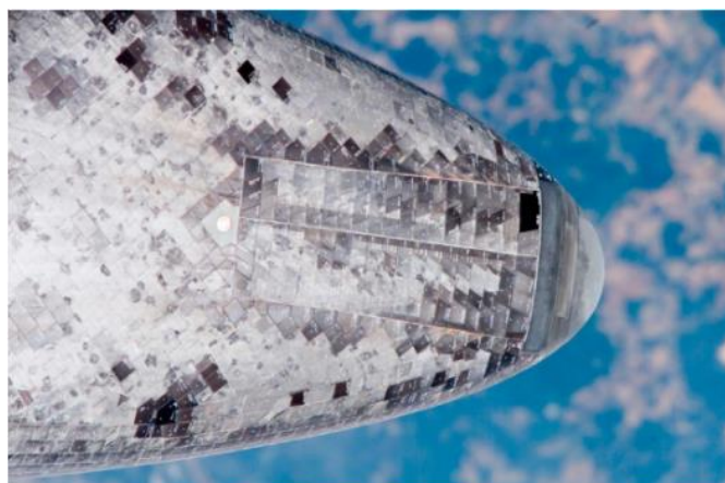
Fig. 3 – Foto de uma seção da parte inferior da cabine da tripulação do Discovery junto a uma série de placas do sistema de proteção térmica (Li-900) (Nasa, 2021).
