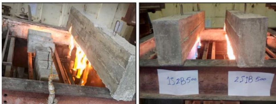
Fig. 83 – Vigas, cubos e cilindros sujeitos a fogo (Hassan et al. , 2021).
