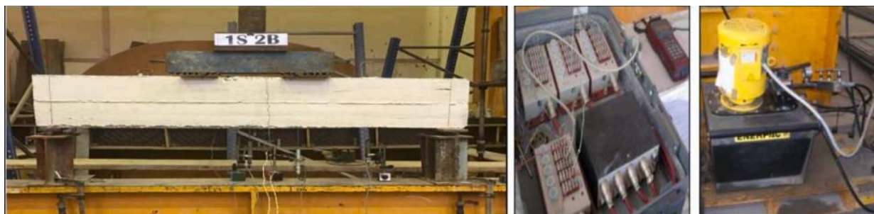
Fig. 84 – Configuração de teste experimental, célula de carga e registrador e leitor de dados (Hassan et al. 2021).
