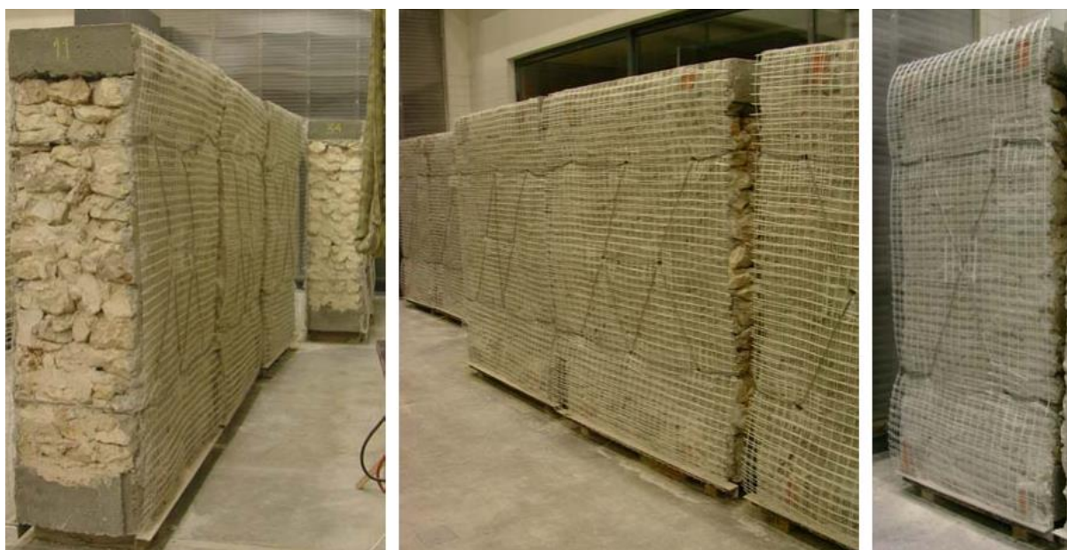
Fig. 52 – Muretes reforçados com confinamento transversal contínuo (Pinho, 2007).
