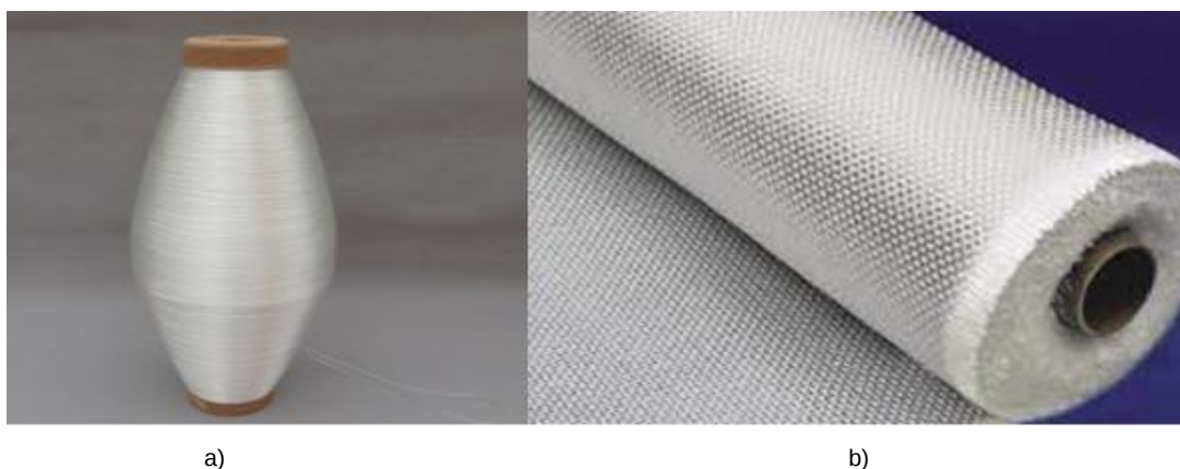
Fig. 21 – Tipos de orientação de fibras de boro a) fios, b) tecido (Silva, 2017).
