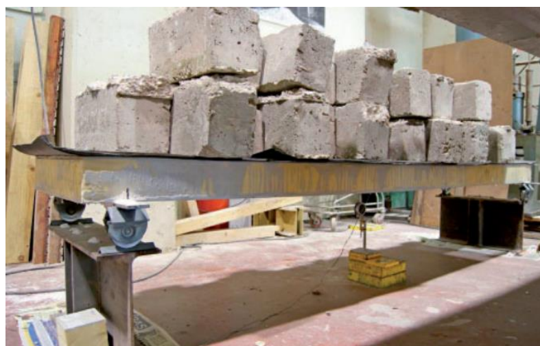
Fig. 64 – Teste de fluência à flexão de painel sanduíche em escala real (Garrido et al. , 2014).
