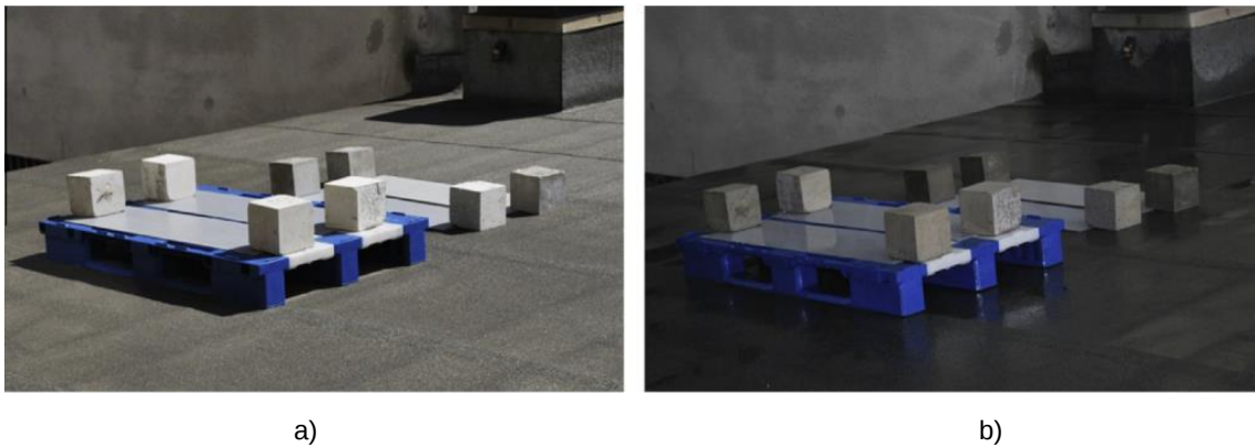
Fig. 57 – Amostras expostas a) durante um dia de verão, b) durante um dia de inverno (Carra e Carveli, 2013).
