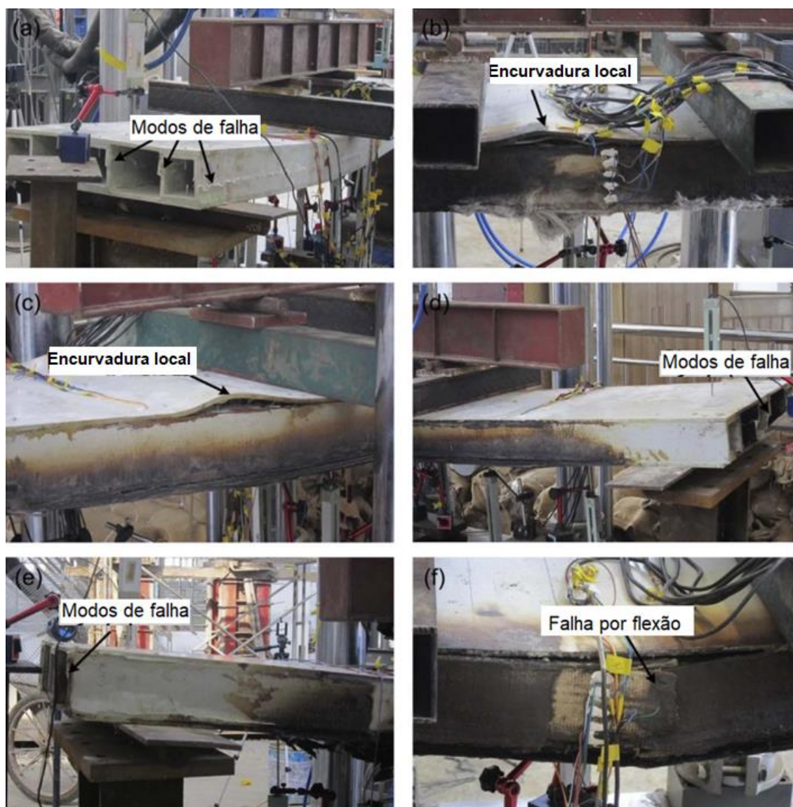
Fig. 72 – Modos de falha das amostras: a) falha por corte da amostra U, b) encurvadura local na amostra GM, c) encurvadura local na amostra GP, d) rotura por corte da amostra GM, e) falha de corte da amostra G, f) falha por flexão amostra CS (adaptado de Zhang et al. , 2018).
