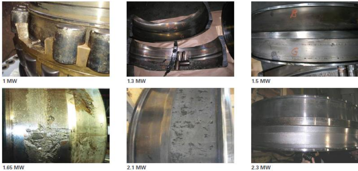
Figura 4.8: Rolamentos do veio principal danificados provenientes de aerogeradores de diversas classes de potência [58].
