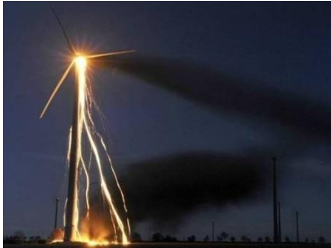
Figura 4.12: Incêndio em aerogerador provocado por rotura da caixa multiplicadora [61].
