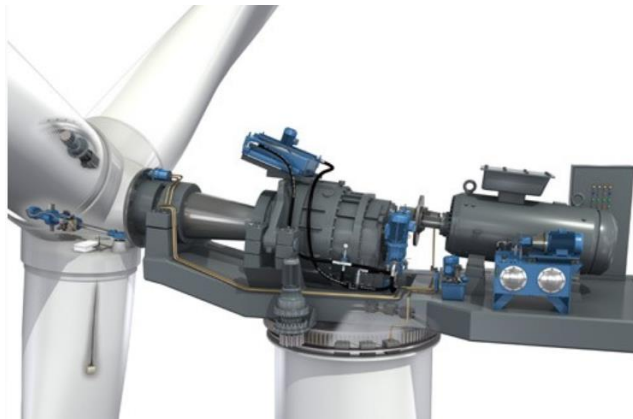
Figura 3.15: Aerogerador com conceito geared drive [26].
