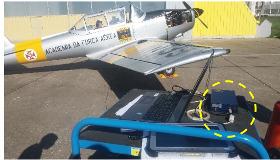
Figura 5-4 Aeronave no local de testes com os cabos de ligação nas asas e o hardware do PROSIG destacado
