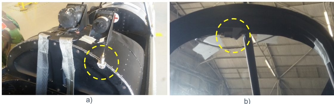
Figura 5-3 a) Acelerómetro da Bruel, instalado no encosto do piloto da frente (#1); b) Acelerómetro da PCB, instalado no aro da canopy (#2)
