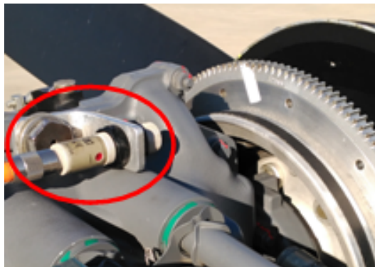
Figura 4-3 Fototach e suporte utilizados na cadeia de medição do Chipmunk, montado no Epsilon numa posição semelhante (FAP, Meditor, IPS, 2017)
