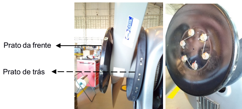
Figura 3-1 Pratos que seguram o cone, instalados na aeronave com a hélice no meio
