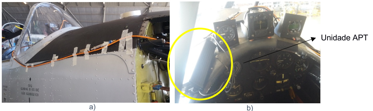
Figura 5-2 a) Fixação dos cabos que vão dos sensores à APT; b) Unidade APT colocada no interior do cockpit
