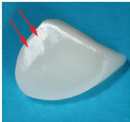
Figura 6. A superfície interna de uma faceta cerâmica feldspática propositadamente condicionada em excesso com 9,5% de HF aplicado por 15 minutos. É visível um "resíduo branco" (combinação de sais de porcelana e detritos de porcelana) e que é difícil remoção. Adaptado de (Gary Alex, 2008).
