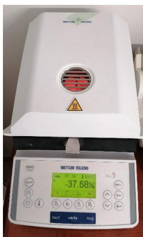
Figura 29 - Analisador de humidade halogéneo (Mettler Toledo H43)
