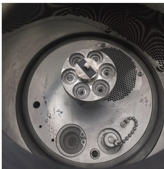
Figura 13. Interior da máquina Quorum Q150T ES, com a amostra preparada para ser submetida ao banho de uma liga metálica de ouro-paládio em vácuo.
