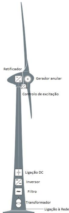
Figura 8- composição primária de um aerogerador Enercon
