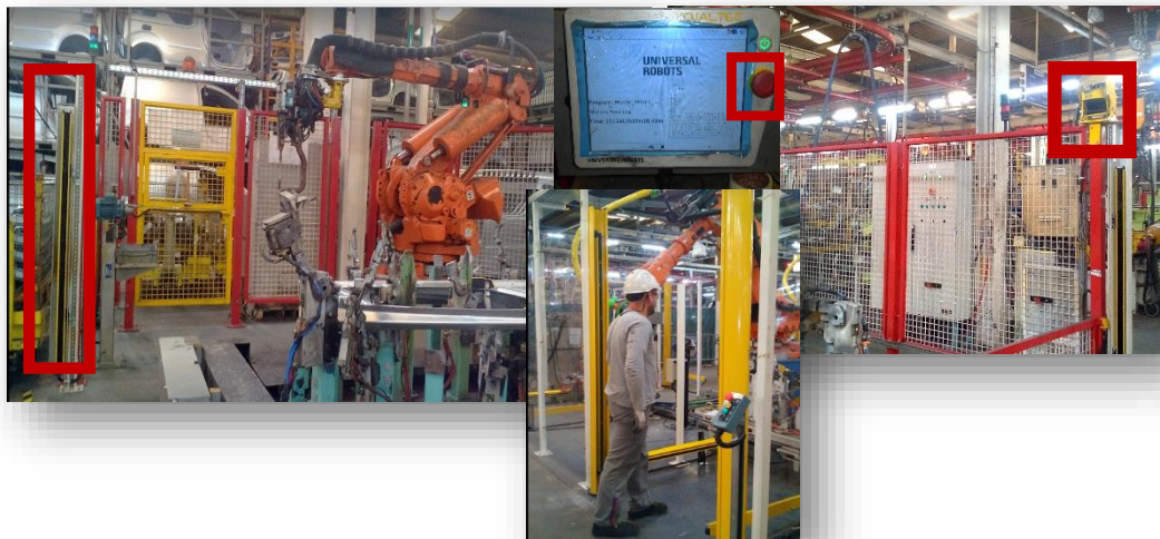
Figura 22- BI , Rotoscanner e botão de emergência na Ferragem e Operador entrar numa Ilha Robotizadas proteção de segurança
